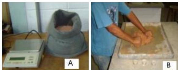
Figura 5 – Processo de medição indireta do peso dos grãos maiores erodidos, (A) bolsas de geotêxtil com os sedimentos mais grossos coletados em campos (B) homogeneização da umidade da amostra.
