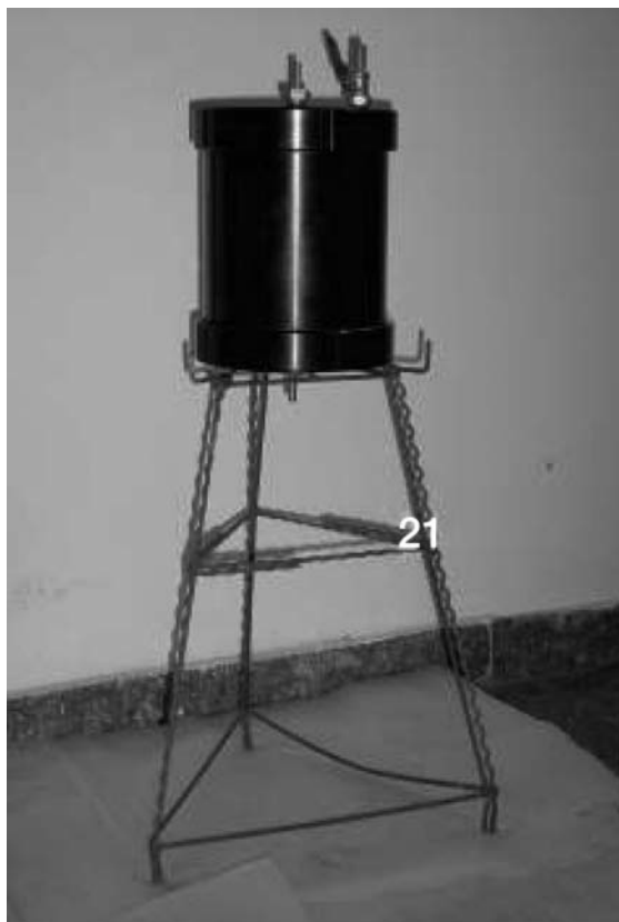
Fig. 5 – Montagem do equipamento em tripé para saturação e drenagem do percolado.
