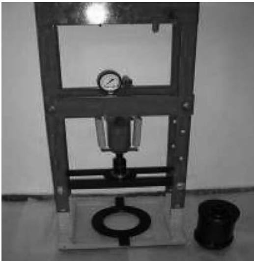
Fig. 8 – Foto a esquerda: equipamento mais conjunto amostrador; Foto a direita: equipamento montado para a coleta de amostras.
