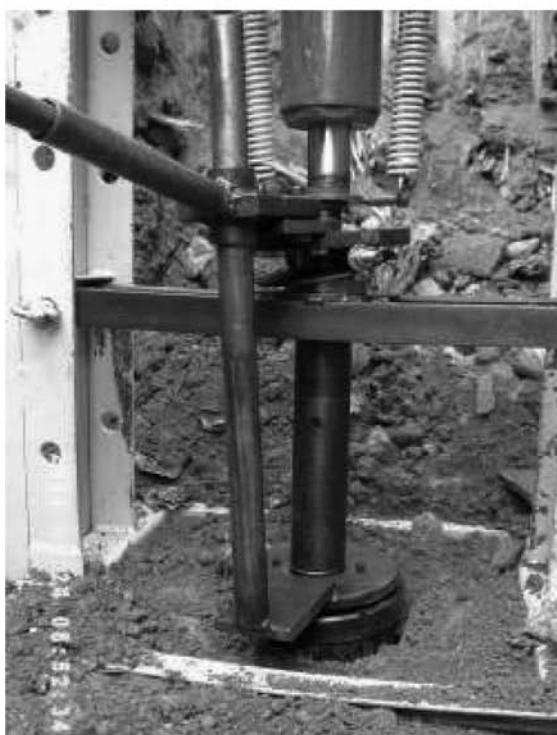
Fig. 6 – Foto superior: em destaque o dispositivo de giro e o apoio de reação superior (pneu) Foto inferior: as alavancas de giro e os prolongadores colocados.
