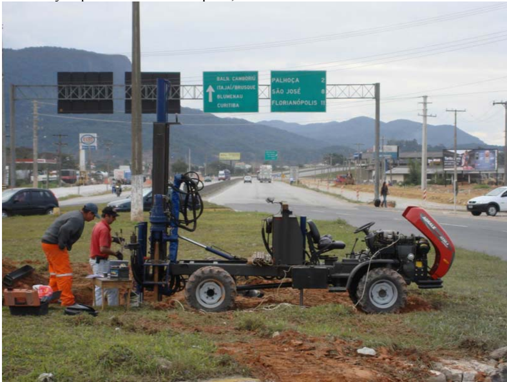
Figure 1. CPT rig on BR-101 Florianópolis, SC, Brazil ( www.geoforma.com.br )
